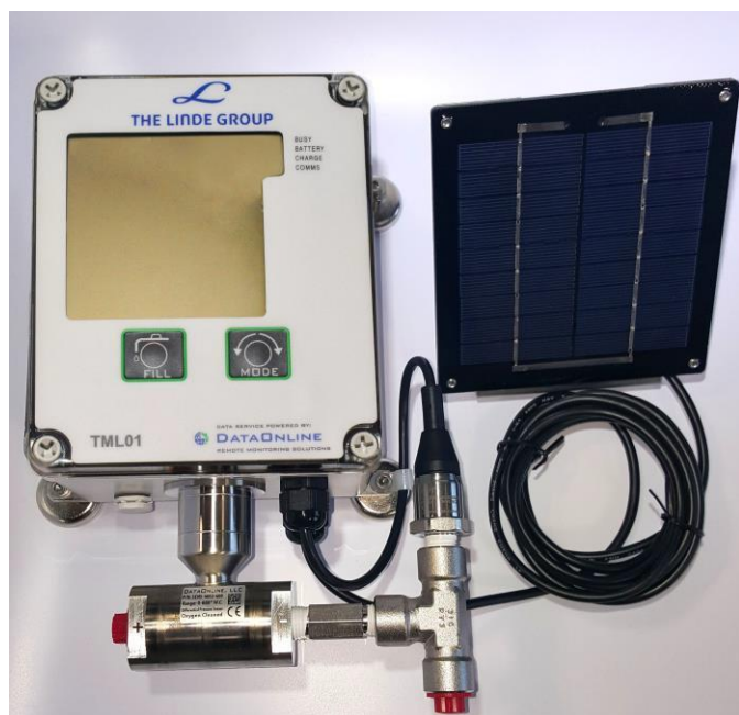
Montaj magnetic RTU
