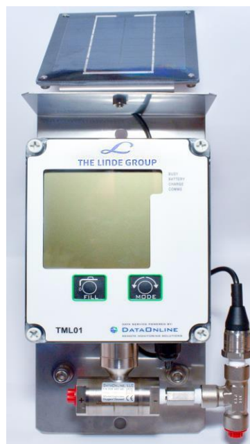
Montaj fix RTU
